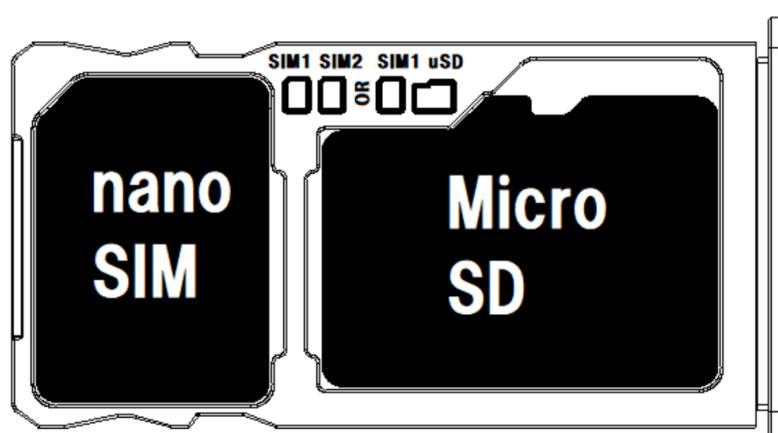
④ トレイを水平に保ち、SIM・microSD カードの位置がずれないように注意しながら、スロットに差し込んでください。
